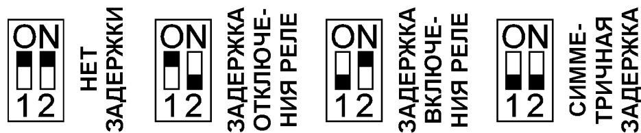
Рис. 6. Внутренние переключатели сигнализатора.
