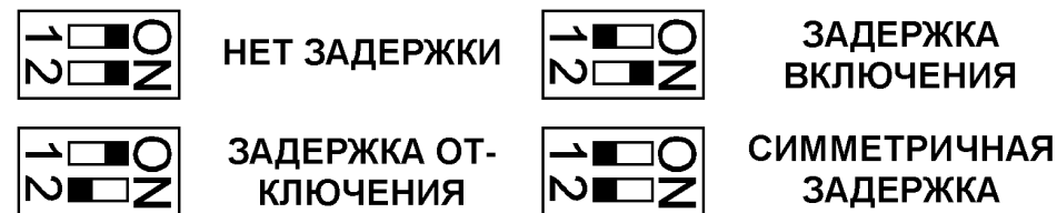
Рис. 11. Внутренние переключатели датчика.
