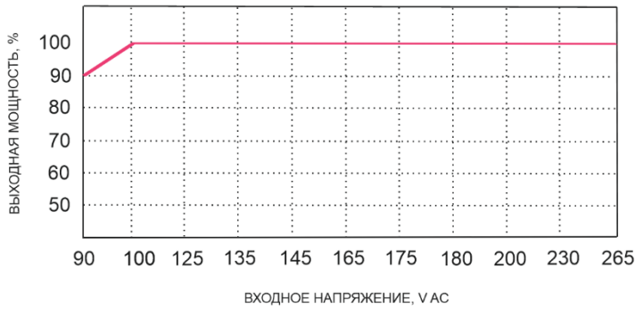
Зависимость выходной мощности от изменения входного напряжения
